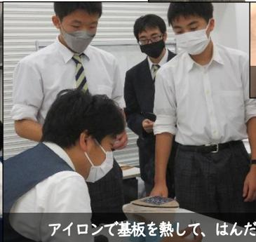
アイロンで基板を熱して、はんだを溶かしています。
