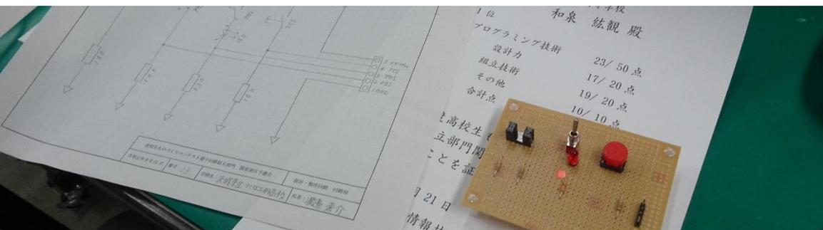
はんだ付け作業（入力回路基板製作）
