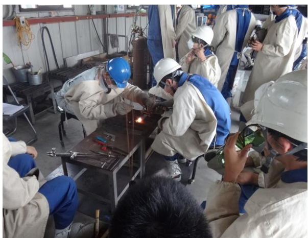
金属の溶け込み具合と溶接棒の使用について 実物を見ながら指導を受けています
